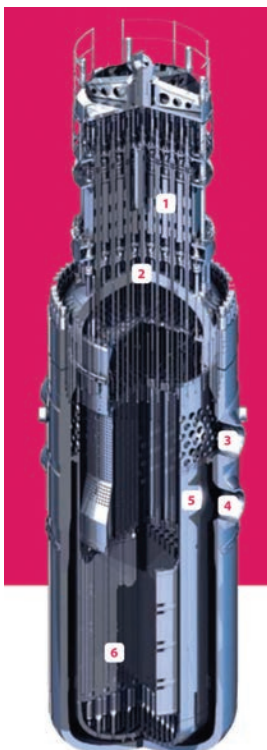
Rys. 7. Przekrój reaktora WWER-1200: 1 – blok przewodnic rurowych z silnikami krokowymi do napędu prętów sterujących; 2 – pokrywa zbiornika; 3 – króćce górne (dysze wylotowe obiegu pierwotnego); 4 – króćce dolne (dysze wlotowe obiegu pierwotnego); 5 – osłona rdzenia; 6 – zespół kaset paliwowych [rys. Rosatom].
